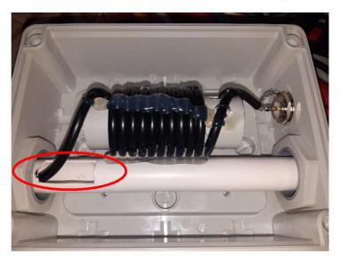
Hier sieht man auch gut, wie das PE Rohr befestigt ist. Ich habe dazu passende PG Verschraubungen genommen und das Rohr praktisch durch die Dose geführt, unten und oben dann mit den PG's geklemmt. Danach habe ich in das Rohr ein Langloch gemacht, damit ich die eigentliche Antenne in das PE Rohr einführen konnte. Oben habe ich den Strahler dann mit heiß Kleber fixiert und verschlossen. Mit Deckel sieht's dann so aus.
